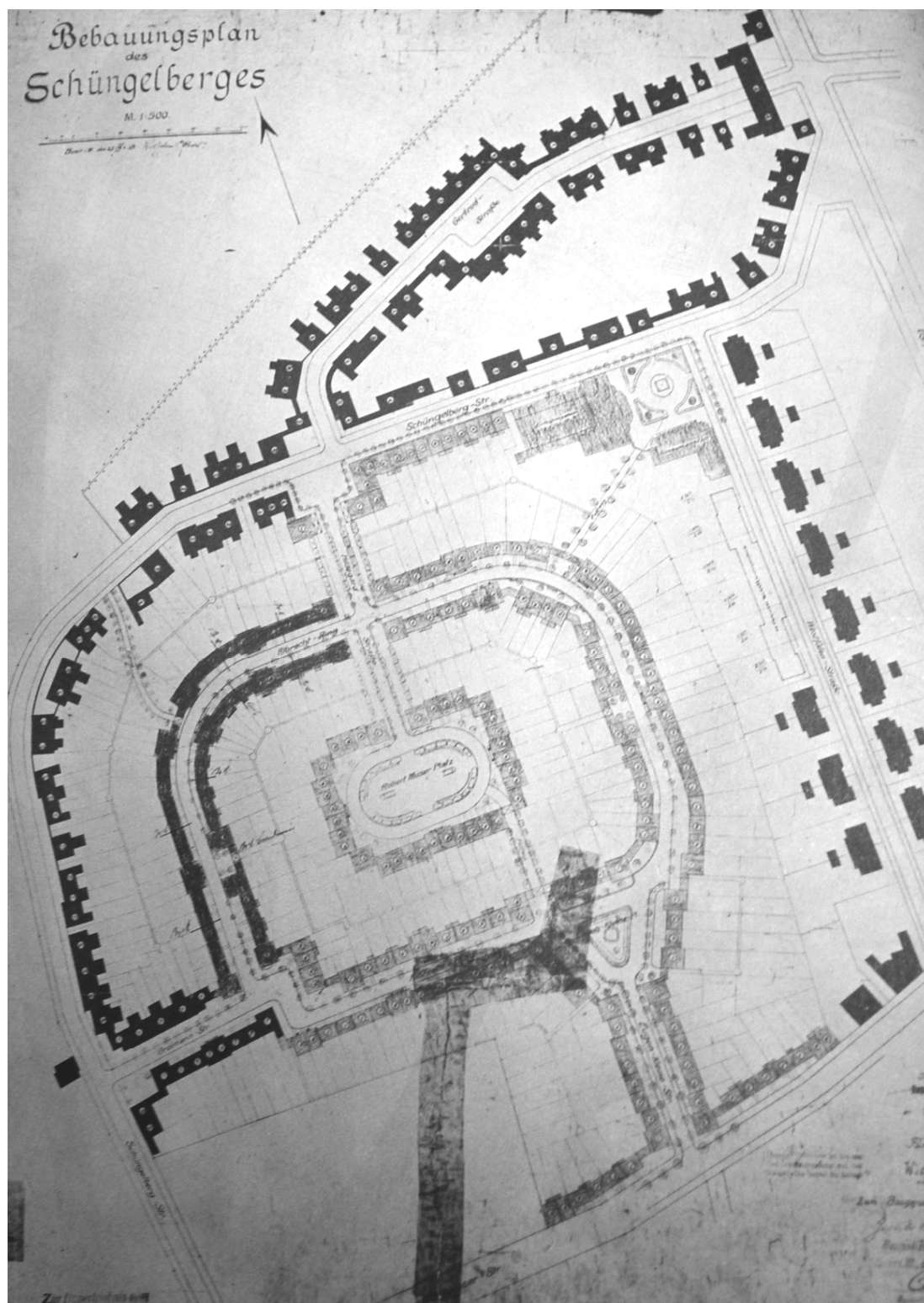
Abb. 251 „Siedlung Schüngelberg“, Bebauungsplan 765 von Wilhelm Johow (schwarz: realisiert; grau: nicht realisiert; am unteren/linken Bildrand würde die „Halde Rungenberg“ anschließen), Quelle: Archiv GE 2009, Originale aus der Bauaktenkammer, 1919
