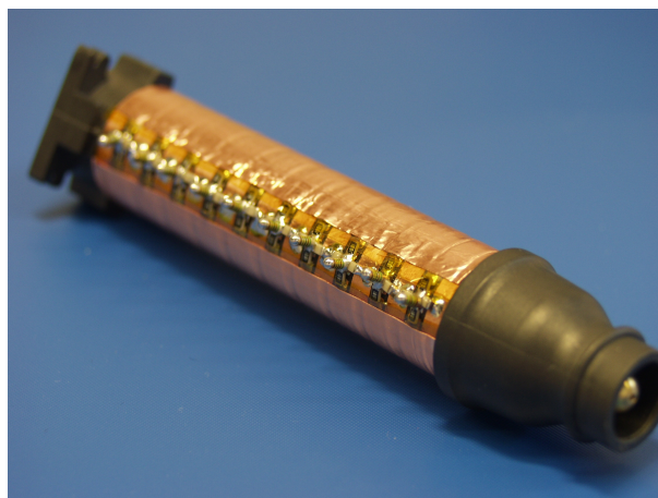
Bild 3.20: Primärspulenkörper mit Sensorelementen bestückt
