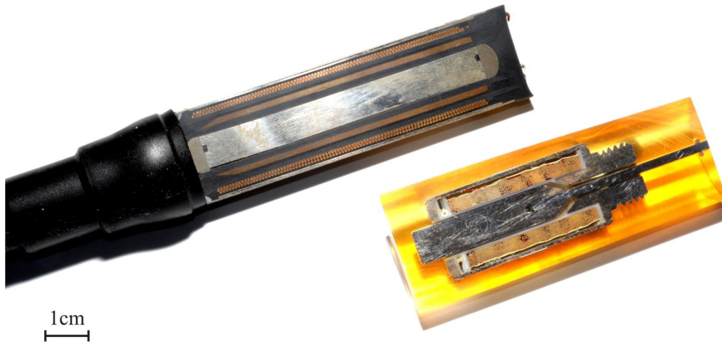
Bild 1.1: Schliffbild eines Zündtransformators und eines Hubmagneten
