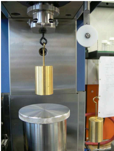
Abbildung 113: Foto der Kalibrierungsvorrichtung mit eingehängten Gewichten für die Kalibrierung der Normalkraft und des Drehmoments
