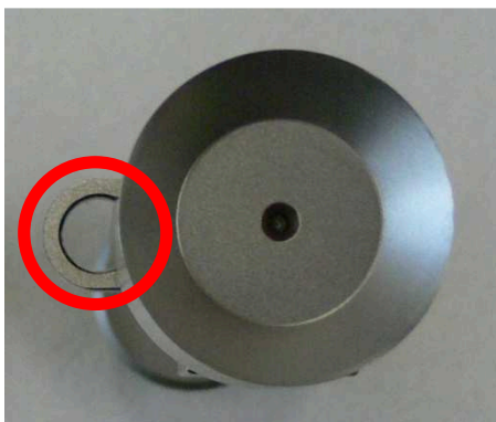
Abbildung 112: Innerer Zylinder des optischen Couette-Systems von unten mit Fenster auf der linken Seite (rote Markierung).
