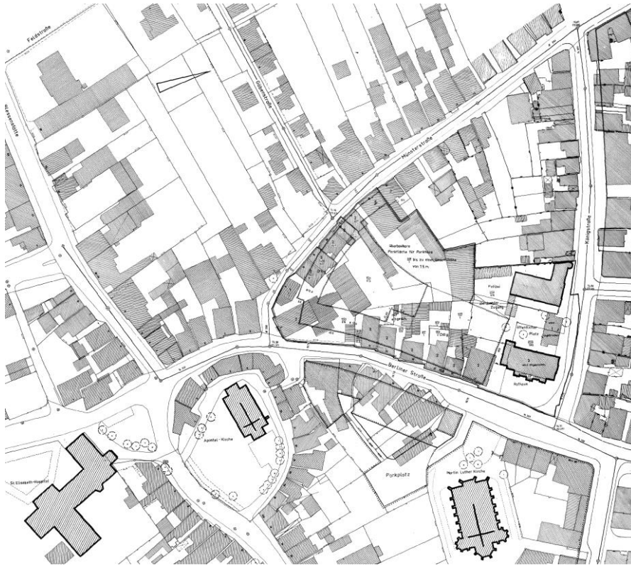
Abb. 81: Durchführungsplan Nr. 16/1 "Berliner Straße zwischen Kökerstraße und Münsterstraße" vom 16.4.1959 (Ausschnitt). Erkennbar die neuen Fluchtlinien und der damit erforderliche Abriss der historischen Bebauung. Quelle: Datenbank der Stadt Gütersloh.
