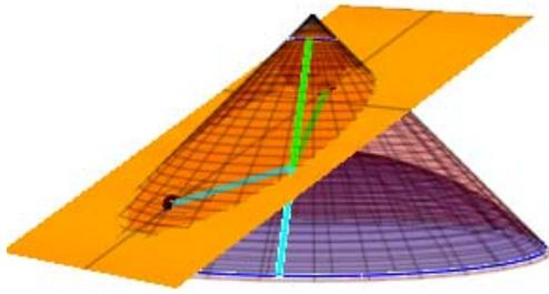
Wird ein Kegel in der gezeigten Weise von einer Ebene geschnitten, so kann man mit den Dandelin'schen Kugeln beweisen, dass die Schnittkurve eine Ellipse ist. Dazu dreht man hier interaktiv die eingezeichnete Mantelstrecke.
