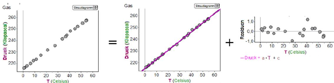
Die Abbildung zeigt beispielhaft, wie ein Datensatz, welcher den Zusammenhang zwischen Temperatur und Druck eines konstanten Volumens Luft in einem luftdichten Metallbehälter abbildet, durch eine lineare Funktion modelliert wird. Mit EXCEL können zu geeigneten naturwissenschaftlichen Fragestellungen adaptive Lernumgebungen realisiert werden, die es
