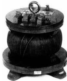
Abbildung 1.5: Transformator von Zipernowsky, Déry und Bláthy (1885)
