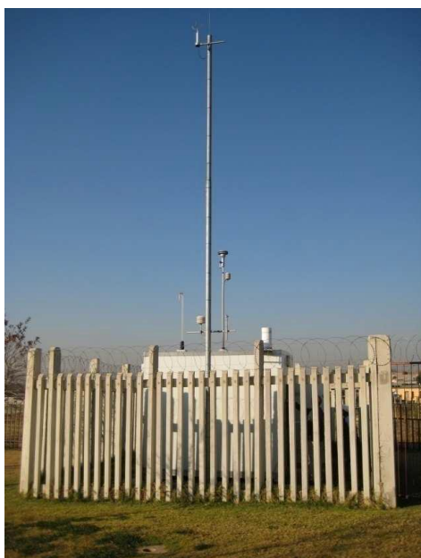
Foto 9: Ortsfeste Messstation der Luftqualität in Olievenhoutsbosch
