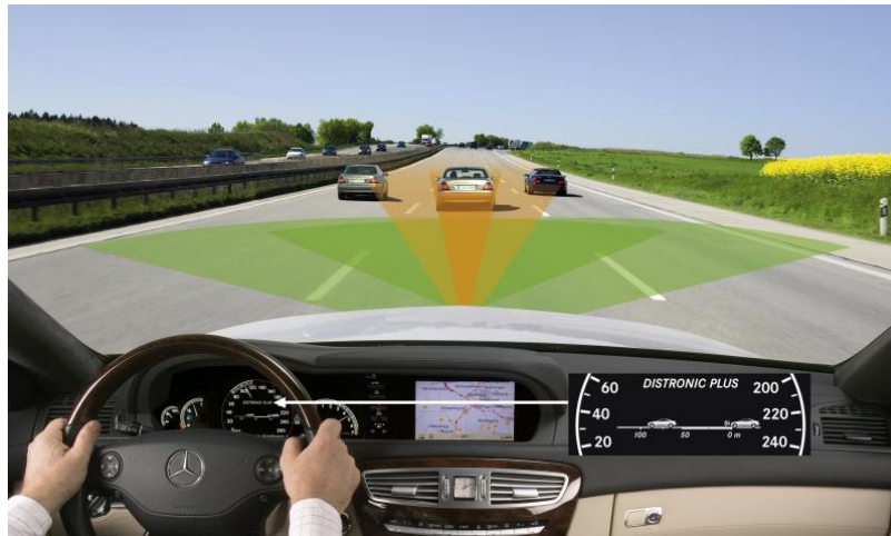
Abbildung 8.4: Symbolische Darstellung von ACC – gemeinsame Situationswahrnehmung von Fahrzeug und Fahrer (Quelle: Daimler AG, http://www.daimler.com/dccom/0-5-1210218-1-1210321-1-0-0-1210228-0-0-135-0-0-0-0-0-0-0.html , Abruf: 31. Januar 2014)
