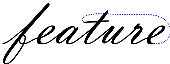
Abbildung 5.9. – Visualisierung des Stiftdruck-Merkmals. Unterbrechungen in der Trajektorie, beispielsweise durch Absetzen des Stiftes, werden interpoliert (hier blau dargestellt) und markiert. Der Stiftdruck ergibt sich durch Einbeziehen der Stiftposition in der dritten Dimension.
