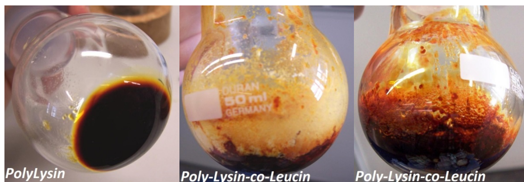
Abb. 3.3.7: Verschiedene Reaktionsansätze direkt nach 2,5 h Polymerisation bei 200 °C in der Mikrowelle (von links nach rechts): reines Polylysin, Polylysin mit 30 Gew.% Leucin nach Almozaik [228] und zuletzt der gleiche Ansatz mit zusätzlichem Vermischen nach ca. 15 Minuten.
