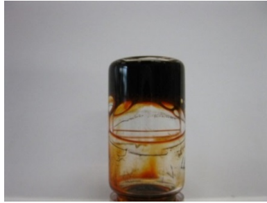
Abb. 3.2.8: Aufnahme eines OHD-Hydrogels mit 6 Gew. % OHD und 0,6 Gew. % Magnetit.
