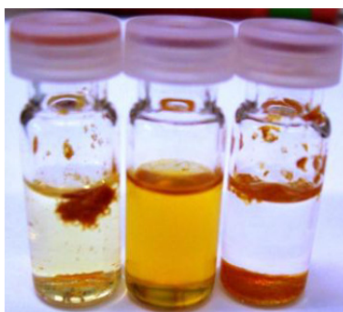
Abb. 3.3.8: Löslichkeit von 10 mg Polylysin-co-Leucin (PLcL), welches 31 Gew. % Leucine enthält, in 1 mL Wasser, Chloroform und Toluol (von links nach rechts).
