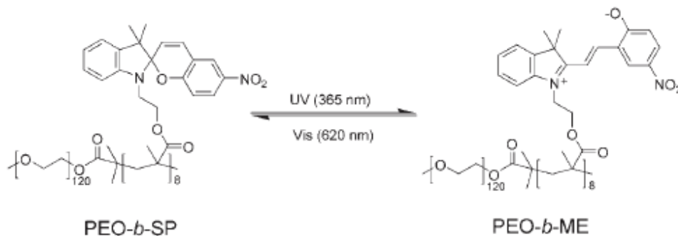
Abb. 1.7: Strukturformel der UV-getriggerten Umwandlung einer an Polyethylenoxid (PEO) gebundenen Spiropyran-Einheit (SP) in das farbige, korrespondierende Merocyanin (ME) [27] .
