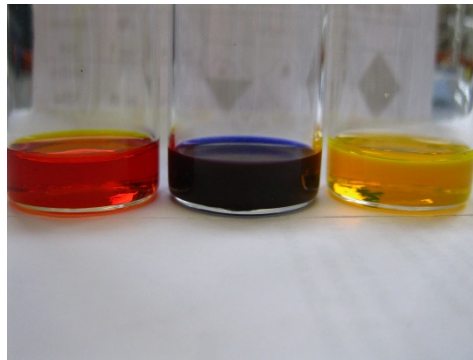
Abb. 3.3.19: Lösung verschiedener Farbstoffe (Bismarck Braun Y, Nilblau A und Fluorescein-Natriumsalz, von links nach rechts) in einer PLcL-Lösung in \text{CHCl}_3 (20 mg/mL) nach 24h Schütteln.
