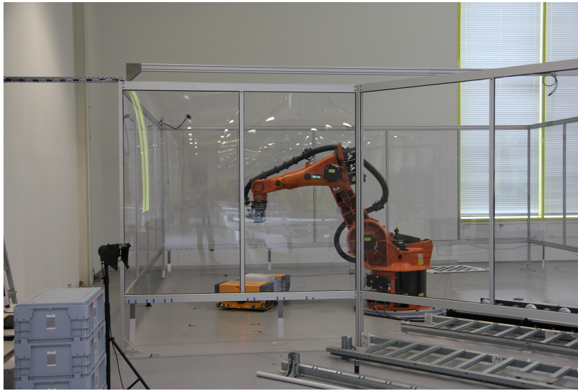
Abbildung 8.1.: Die Roboterzelle in der ZFT-Halle. Die CCD-Kamera ist in der hinteren linken Ecke der Roboterzelle befestigt.
