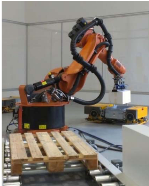
Abbildung 5.2.: Aufnahme des Industrieroboters Kuka 125/3 beim Entladen der fahrerlosen Transportfahrzeuge 2
