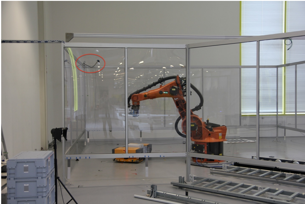
Abbildung 7.2.: Anbringung der CCD-Kamera im Roboterkäfig
