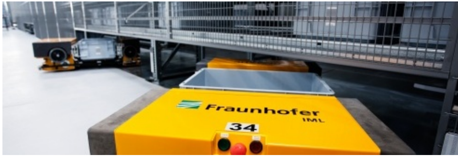
Abbildung 7.10.: Die FTF des Fraunhofer Instituts besitzen einen sehr markanten Orangeton, deren zugehörige Punkt看ke durch einen Farbfiler aus der Punkt看ke extrahiert werden können.
