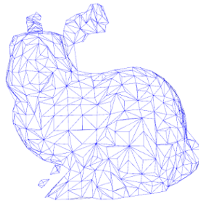
Abbildung 4.6.: Triangulierung einer Punktwolke [21]
