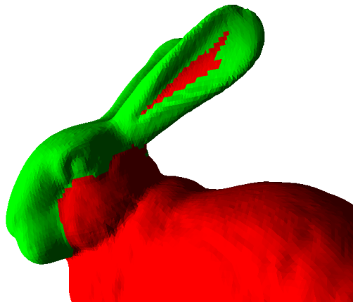
Abbildung 5.5: Auswirkung einer falschen Berechnungsreihenfolge: Das rote Patch zerfällt in zwei nicht-zusammenhängende Teile.
