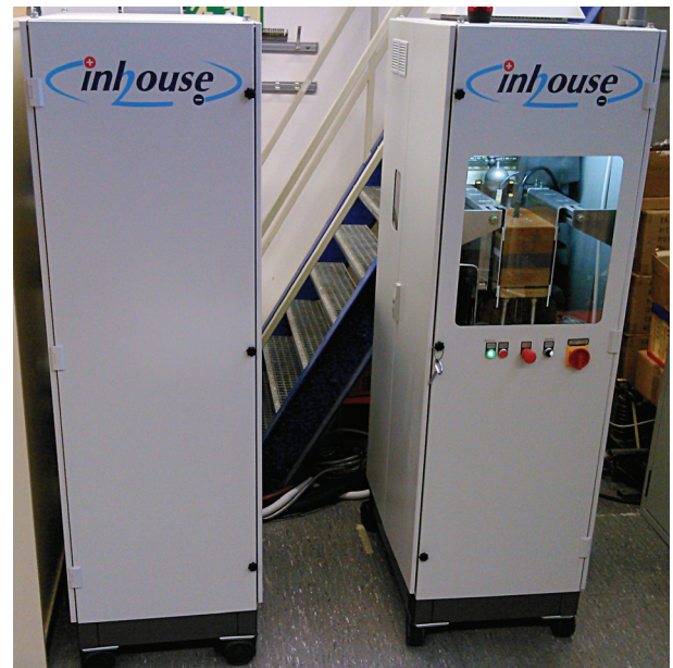
Abbildung 3. Langzeit-Teststand (rechts) mit BHKW-Simulator (links)
