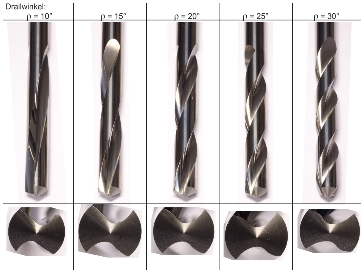
Abbildung 6-27: Einfluss des Drallwinkels \rho auf die Werkstückgestalt
