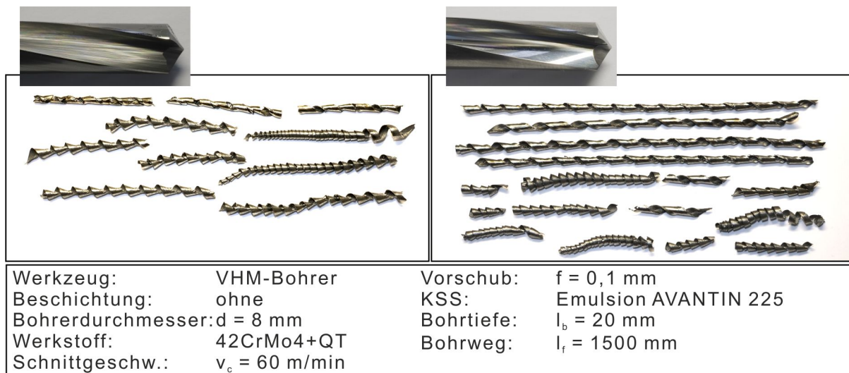
Abbildung 7-5: Spanbildung im Vergleich zwischen nachbehandelten und unbehandeltem Bohrwerkzeug
