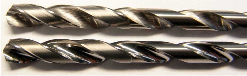
Abbildung 6-2: Vergleich einer polierten (unten) und einer nicht polierten (oben) Spannuten an einem wendelgenuteten Tiefbohrwerkzeug
