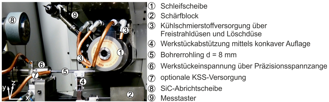
Abbildung 5-2: Versuchsaufbau während der Untersuchungen zum Nutenschleifen
