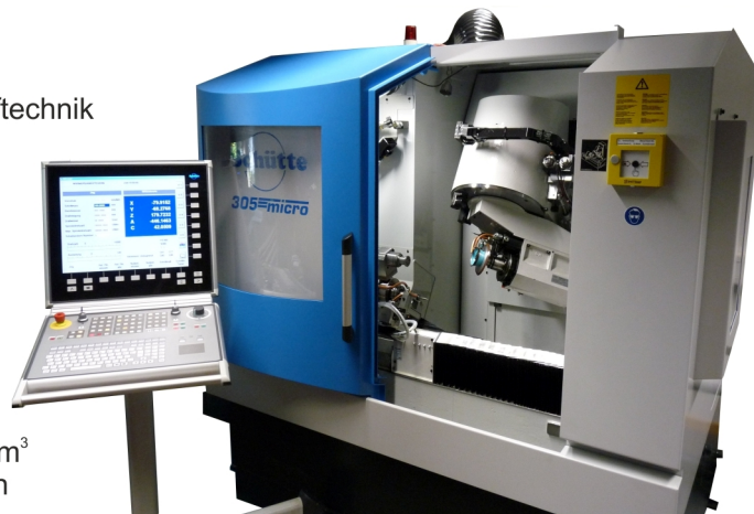
Abbildung 4-1: Kenndaten der eingesetzten Versuchsmaschine Schütte 305micro
