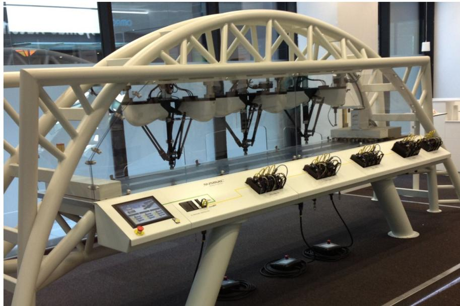
**Abbildung 1.1:** Omron „Pick and Place“-Anlage mit drei Delta-Robotern [7].
