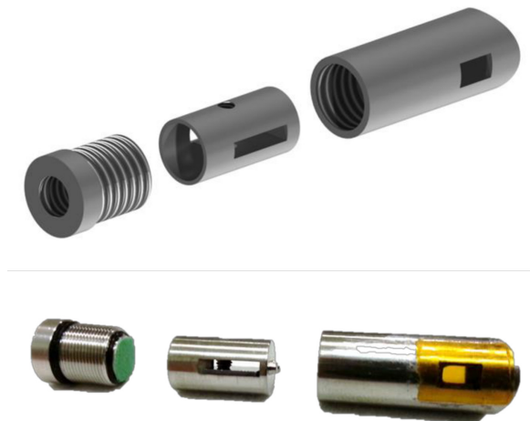
Abbildung 4.3: Die innere Probenzelle. Oben: Schematische Darstellung der einzelnen Bauteile. Unten: Fotografie mit bereits angebrachter Gummimembran, O-Ringen und eingespanntem Wafer.
