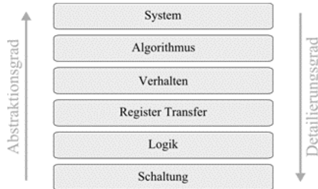
Abbildung 45: Abstraktionsebenen zur Entwicklung elektronischer Komponenten [46]
