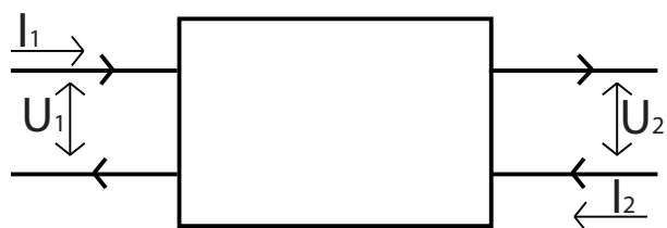
Abbildung 7.1.: Vierpol und Vierpolparameter
