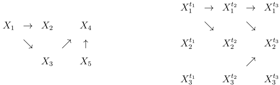
Abbildung 1: Schematische Darstellung eines statischen Netzwerks mit fünf Variablen (X_1, \dots, X_5) (links) und eines dynamischen Netzwerks mit drei Variablen und drei Zeitpunkten (t_1, \dots, t_3) (rechts).
