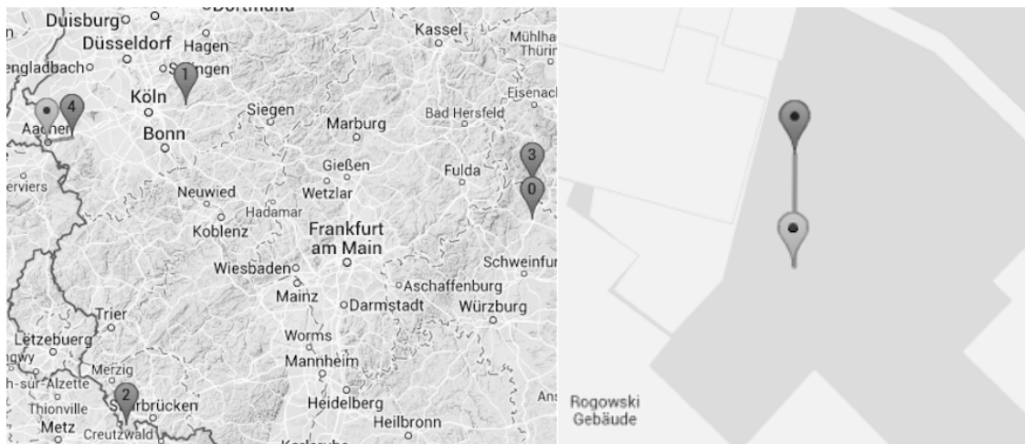
Abbildung 2: links: Auswirkungen der verschiedenen Modellverbesserungen: (0) keine Verbesserung, (1) Satellitenuhr, (2) Empfängeruhr, (3) Form der Erde, (4) alle Satelliten; rechts: Alle Modellverbesserungen zusammen liefern eine gute Näherung für die Empfängerkoordinaten.
