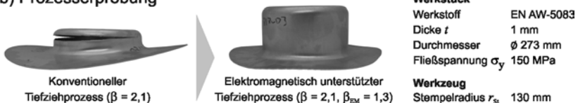
a) Einfluss der Spulenposition auf die Spannungsreduktion und b) resultierende Bauteilgeometrien
