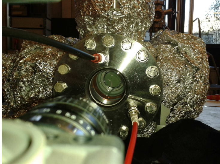
Abbildung 7.10: Der Blick durch das Flanschfenster auf den Schirm. Im Vordergrund ist die CMOS-Kamera zu sehen, die auf den Schirm ausgerichtet ist. Für die Messung der Lichtintensitäten des Schirms wird der Aufbau abgedunkelt.
