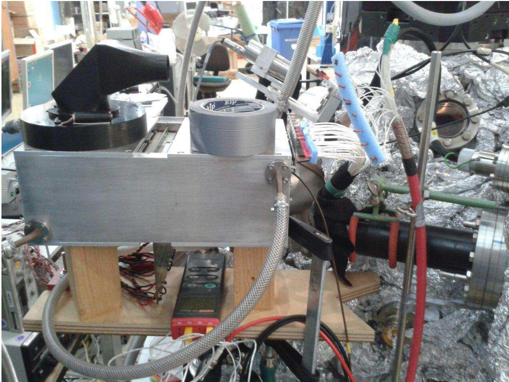
Abbildung 7.16: Der Aufbau der Elektronik am Spektrometer kurz vor der ersten Messung mit SiPMs. Im linken Bildbereich ist das Gehäuse der Elektronik zu sehen. Rechts am Flansch befindet sich das schwarze Gehäuse der optischen Abbildung. Am linken Ende der optischen Abbildung sind die weißen Signalleitungen der einzelnen SiPMs zu erkennen, die zur Ausleseelektronik führen.
