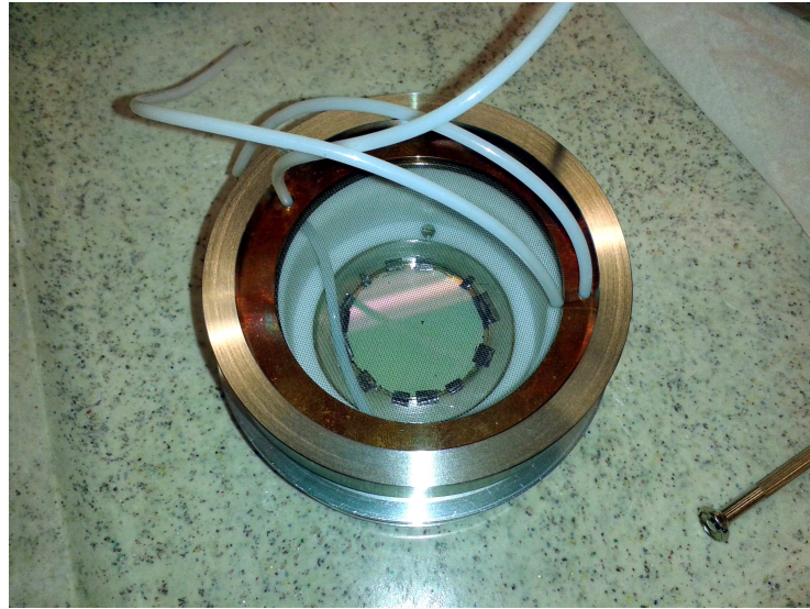
Abbildung 7.4: Abgebildet ist der vollständig zusammengesetzte HV-Detektor. Er wurde beim Zusammenbau direkt in die Spektrometerdose eingebaut, die in den Ausgang des Spektrometers eingesetzt werden kann.
