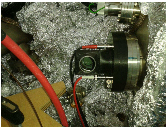
(a) Der Fensterflansch mit angebautem Periskopaufsatz zur Überprüfung der Leuchtschirmaktivität.
