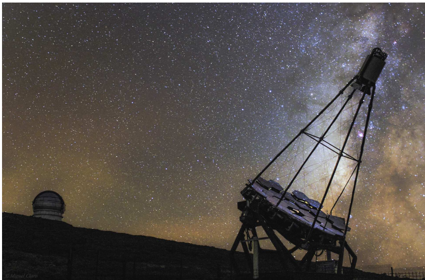
Abbildung 4.1: Foto des Cherenkov-Teleskops FACT während der nächtlichen Datennahme. Die komplette Elektronik, mit Ausnahme der Spannungsversorgung, befindet sich im zylindrischen Kameragehäuse oben rechts im Bild. [6]
