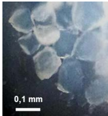
Abbildung 10 Durchlichtmikroskopie-Aufnahme mit vierfacher Vergrößerung der synthetisierten Tb-mesoMOF-Kristalle in Methanol.
