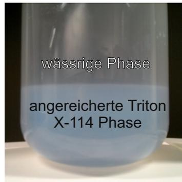
**Abbildung 2.3:** Dargestellt ist die Phasentrennung zwischen der oberen wässrigen Phase und der unteren mit Triton X-114 angereicherten Phase.
