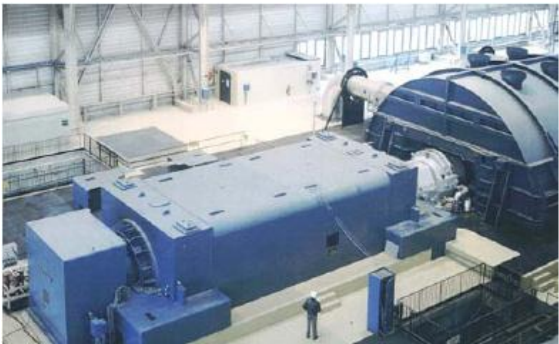
Abbildung 1.3: Vierpoliger Turbogenerator mit einer Leistung von 1700 MVA [1]
