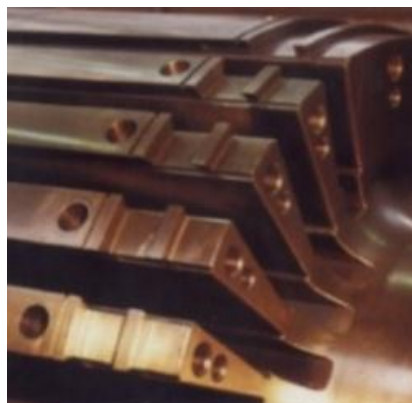
Abbildung 4.3: Axialer Lufteintritt in den Rotor durch Nutgrundkanäle
