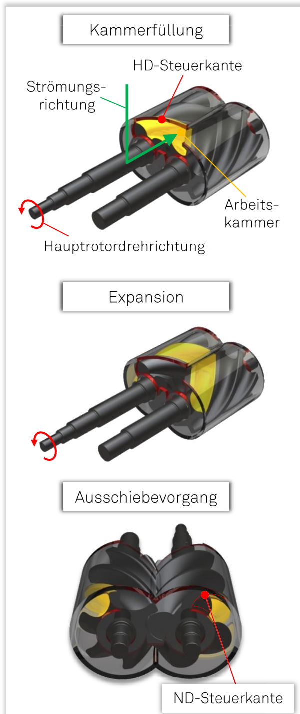
Bild 2.5: Drei Phasen des Arbeitsspiels von Schraubenmotoren.
