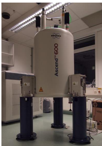
Figure 2: 600 MHz Bruker AV III NMR spectrometer at the ISAS institute in Dortmund.
