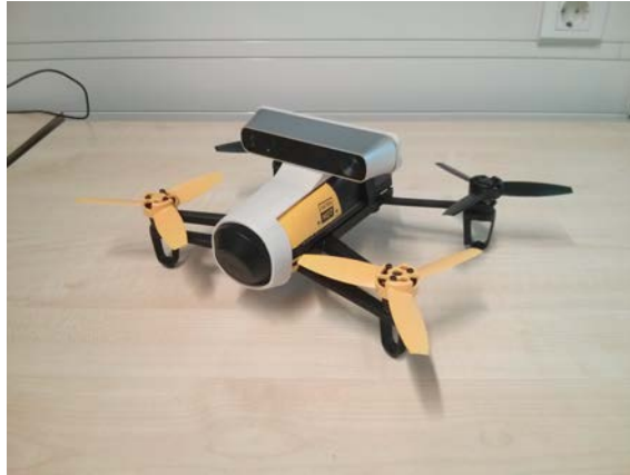
Abbildung 3.3.: Tiefensensor „Structure Sensor“ auf der Drohne montiert
