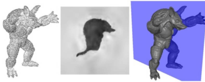
Abbildung 6.14.: Ergebnis einer Poisson Oberflächenrekonstruktion: Startpunktwolke (links), Indikatorfunktion \chi (mitte) und 3d-Modell (rechts) Die Abbildung ist aus dem Paper Poisson surface reconstruction von Kazhdan et al. [46].
