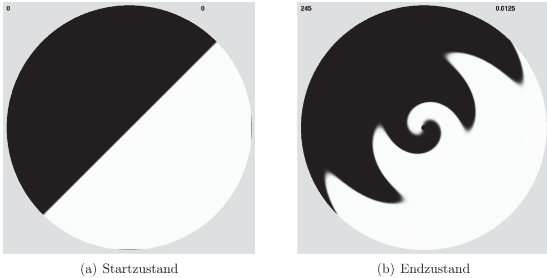
Abbildung 2.0.1: NATD-Operator angewendet auf ein Schwarz/Weiß-Gebiet. Strömungsfeld tangential zur Radialrichtung und Stärke definiert als Sinusfunktion vom Radius. Parameter: c=300 , \epsilon=0.01 , \rho=8 .
