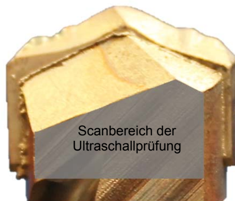
Abbildung 6.5 Darstellung des Scanbereichs der Ultraschallprüfung in Tauchtechnik auf der Stirnfläche des gelöteten Bohrkopfes
