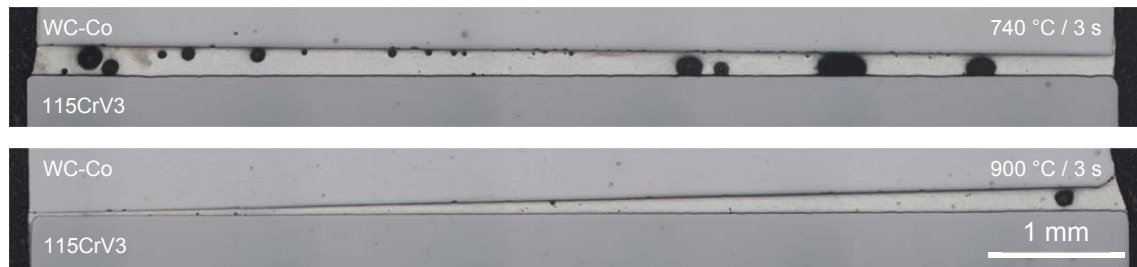
Abbildung 5.32 Lichtmikroskopische Übersichtsaufnahme zweier Lötspalte bei einer Prozesstemperatur von 740 °C bzw. 900 °C und einer Haltezeit von 3 s
