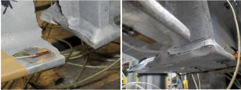
Bild 3.26: Typischer Bruch an Walzprofil mit Quersteife [116]
