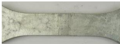
Bild 3.40: Sichtbare Zinkschichtüberhöhung im Bereich der DV-Schweißnaht [116]
