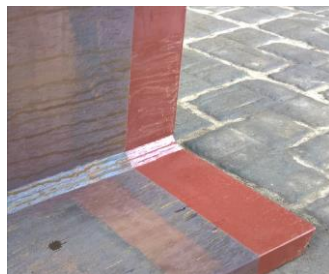
Bild 8.2: Träger vor dem Verzinken mit Abdecklack im späteren Stoßbereich
