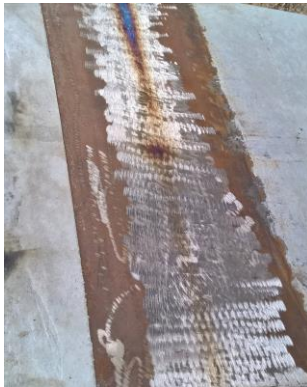
Bild 8.3: Träger nach dem Zusammenschweißen mit entferntem Abdecklack (links: scharfkantiger Übergang, rechts: fransig ohne gerade Abgrenzung)
