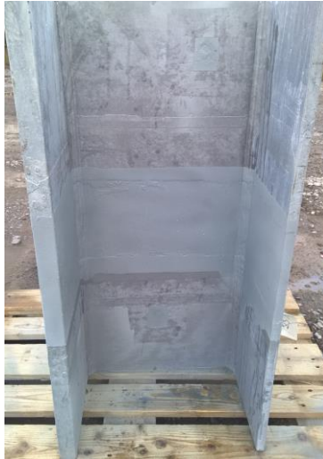
Bild 8.5: Bauteilähnliche Probe mit Spritzverzinkung und Versiegelung
