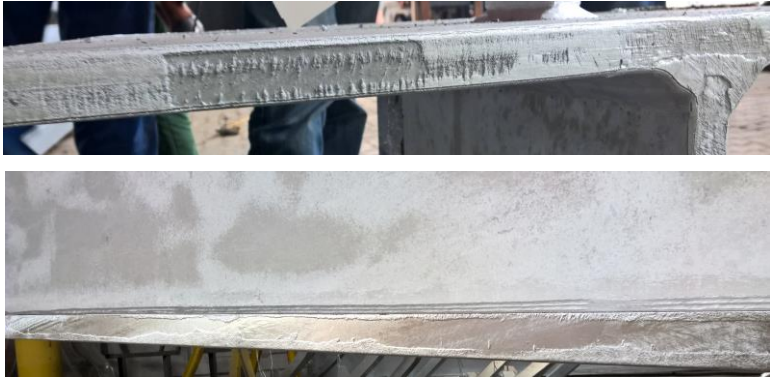
Bild 8.7: Gestörte Zinkannahme an Schnittflächen mit nicht ausreichender Nachbearbeitung
