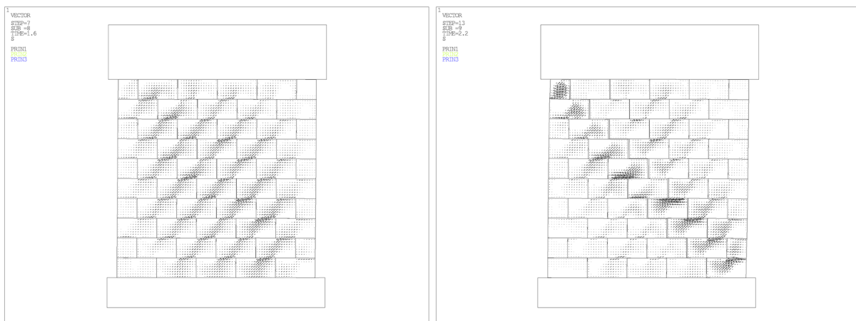
Bild 5.16 WV01: Hauptzugspannungstrajektorien links: d = 0,6 \text{ mm} - rechts: d = 1,2 \text{ mm}
