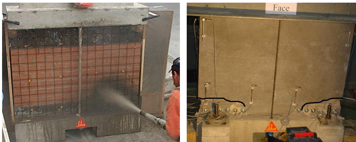
Bild 2.15 Ergänzung einer bewehrten Spritzbetonschicht (l) – Ende des Versuchs (r) [E8]
