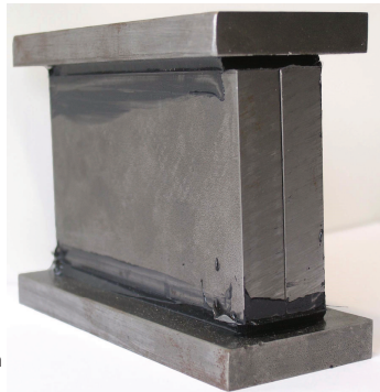
Bild 4.8 Versuchskörper der Druckversuche zum Tragverhalten der Verklebung an den Lasteinleitungsstellen
