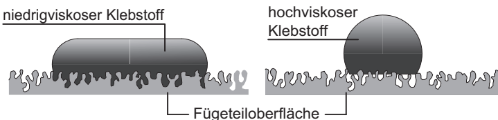
Bild 2.10 Benetzungsverhalten eines hoch- und niedrigviskosen Klebstoffs nach [28]
