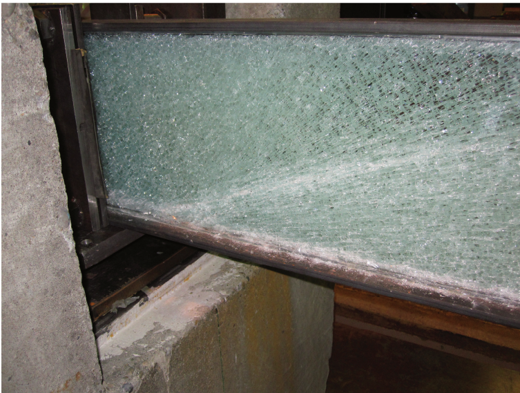
Bild 4.46 Schrägriss am Auflager des Versuchsträgers TS6
