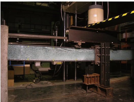
Bild 4.61 Versuch zur Resttragfähigkeit des Versuchs TS4 am Versuchsende
