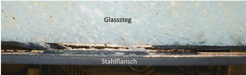
Bild 4.23 Adhäsives Versagen des Klebstoffes im Versuch TS3
