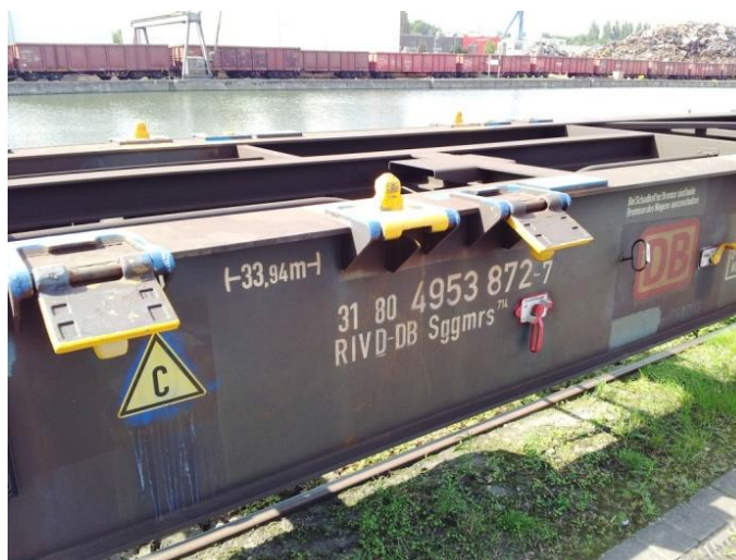
Abbildung 35: Schienentransport – Eingesetzter Gelenk-Containertragwagen ([Sie14a], S. 36)
