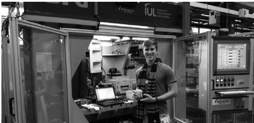
RISE-Austauschstudent Logan Gable vor der Mehrachspressen zur inkrementellen Blechmassivumformung
