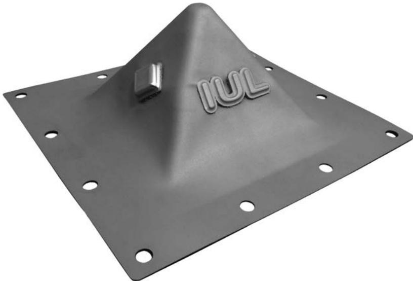
Inkrementell umgeformter Pyramidenstumpf mit additiv aufgebracht und spanend nachbearbeiteten Nebenformelementen
