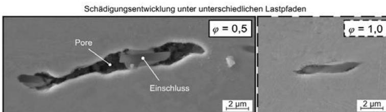
Lastpfad bei unterschiedlichen Umformgraden und resultierende Schädigungsentwicklung
