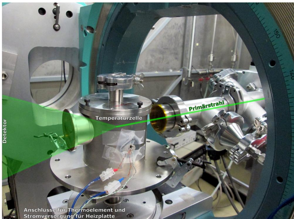
**Abbildung 4.4.:** Messaufbau mit Temperaturzelle an der Strahllinie BL9
