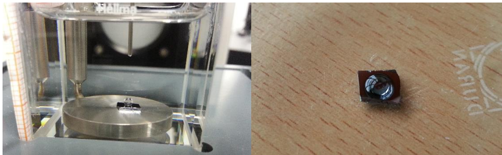
Abbildung 29 Platzierung einer Kapsel auf einem Siliciumwafer als Objektträger für die AFM und REM, links: noch in der Ölphase, rechts: zum Trocknen an Luft.
