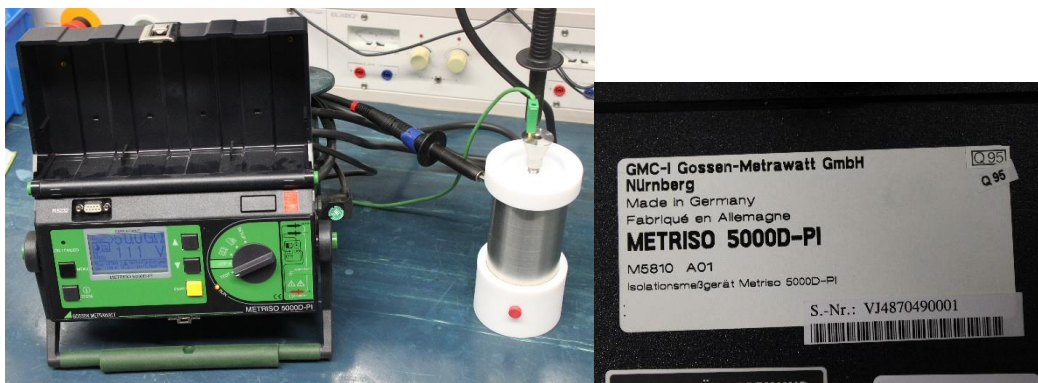
Abbildung 36 Multimeter METRISO 5000D-PI für die zeitabhängige Isolationsmessung mit wählbaren Spannungen bis 5000V DC
