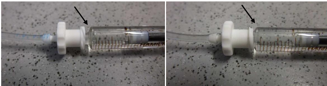
Abbildung 96: Undichtigkeit der Luer-Steckverbindung (vgl. S.144). A: Ein neuer weiblicher Luer-Adapter wurde auf den konischen Luer Ansatz der Spritze aufgesteckt und führt zu einer dichten Verbindung. Durch häufigen Gebrauch dehnte sich der Kunststoff minimal aus und der Adapter musste immer weiter auf den Luer Ansatz aufgeschoben werden. In B ist der Kunststoff bereits so stark gedehnt, dass er an der Erweiterung der Glasspritze anstößt. Dadurch ist die Steckverbindung nicht mehr verlässlich dicht. Eine Lösung des Problems war, den Anschluss mit Parafilm zu umwickeln, was zu einer dauerhaft dichten Verbindung führte.
