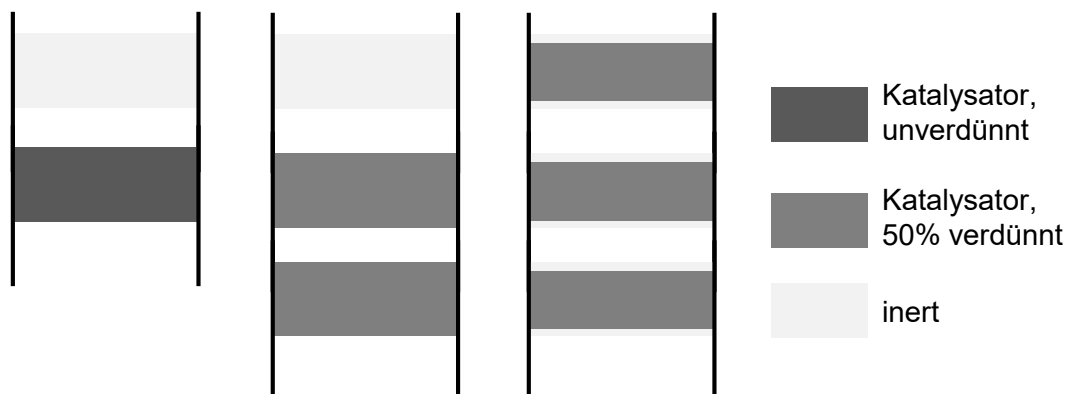
Abbildung 5-18: Untersuchte Reaktorkonfigurationen mit bis zu drei katalysatorhaltigen SR-Modulen.
