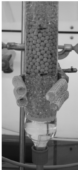
Abbildung 4-4: Experimenteller Versuchsaufbau zur Bestimmung der Stoffübergangskoeffizienten im Festbettreaktor. Der Einlass befindet sich am unteren Bildrand, es folgt ein Partikelrückhalt und Glaspartikel als Einlaufstrecke. Im anschließend markierten Bereich befinden sich die fabrizierten Ionentauscher.
