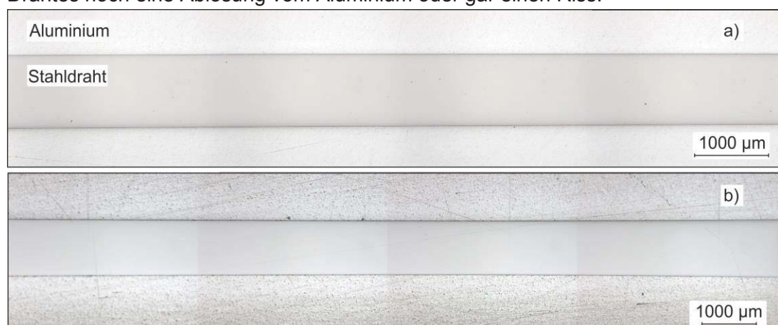
Abbildung 14: Eingebetteter Draht in der Aluminiummatrix a) 1,2 % gedehnt und b) ungedehnt
