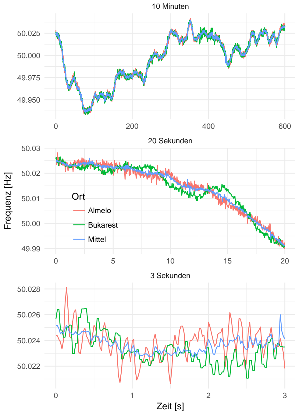
Abbildung 2.2: Verlauf der Netzfrequenz am 1. Dezember 2014, in Betrachtung verschieden langer Ausschnitte und jeweils beginnend um 0:00:00 Uhr. Der Mittelwert wurde aus allen fünf Messorten berechnet, nicht nur aus den zwei dargestellten.
