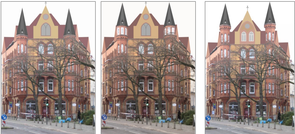
Abbildung 237 Proportionsstudie 10 Drostestraße 1, erarbeitet vor dem Auffinden der historischen Bilder: Links ist die Ansicht mit neuen Turmhelmen nach Abtragen der Turmaufstockungen und hohem zentralen Giebel abgebildet, im mittleren Bild sind die Helme auf die Aufstockungen gesetzt und rechts wurden die Türme mit Turmkranzsimsen verlängert
