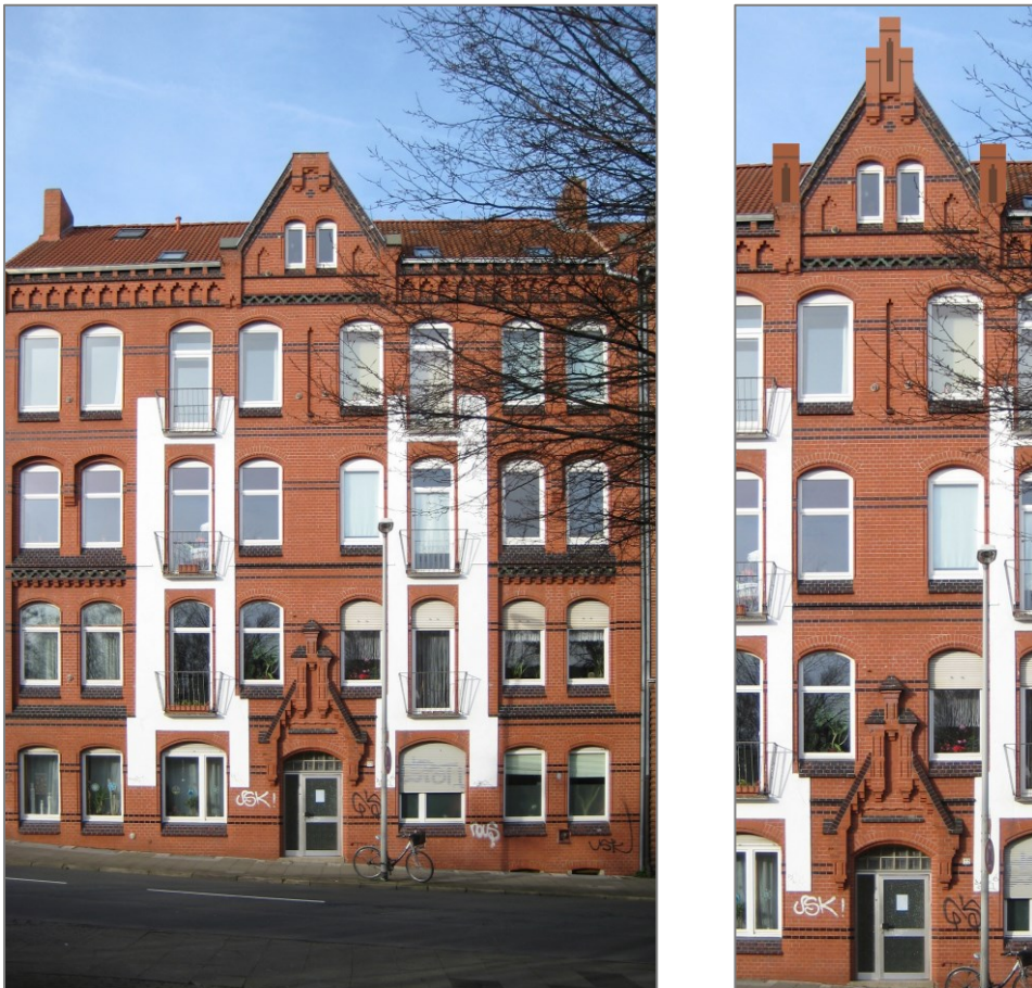
Abbildung 59 Abgebrochene Balkone 34 Am Lindener Berge 22. Rechts ist die Wiederherstellung des Giebels skizziert. Das Motiv wurde ähnlich der Wimperge über dem Eingang entworfen, obwohl die noch vorhandenen Basen der Mittelstaffeln sich von dieser unterscheiden
