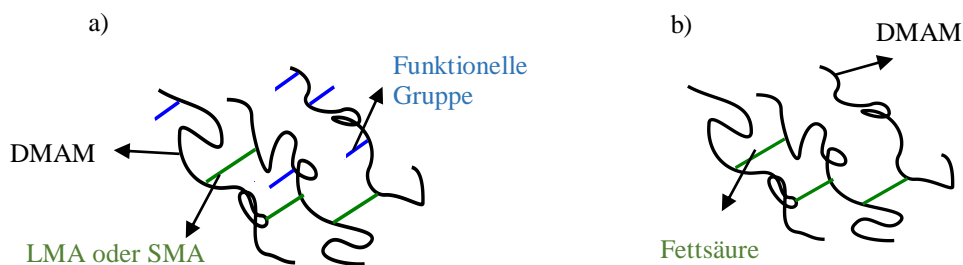
Abb. 1. Schematische Abbildung für hydrophob-modifizierte Copolymere mit a) funktionellen Gruppen und b) Fettsäuren.
