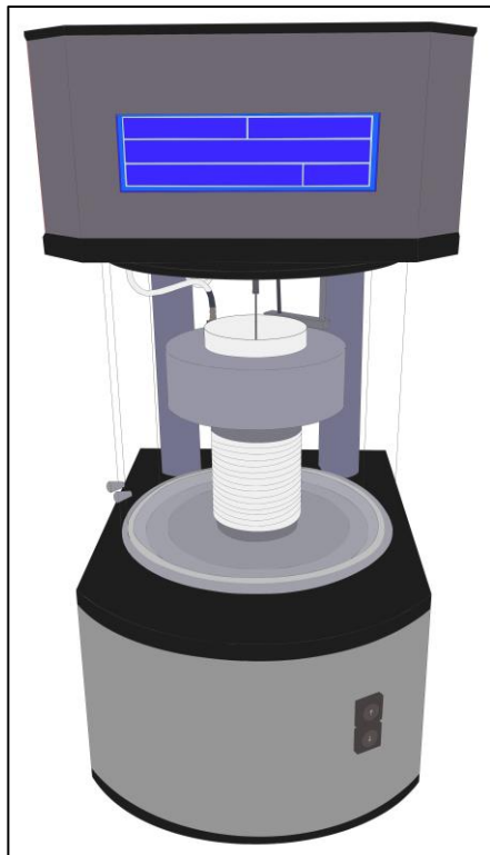
Abb. 20: Schematische Darstellung des DCAT 25 Tensiometers der Firma DataPhysics
