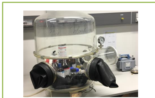
Abbildung 23: Glovebox zur Lagerung der Chemikalien und Herstellung der Lösungen unter Argonatmosphäre.
