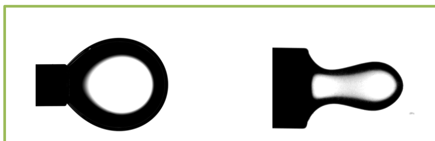
Abbildung 74: Aufnahmen der Tropfen am Pendant-Drop -Tensiometer. Bei einer ODMS-Grenzflächenkonzentration von 60 Molekülen/nm 2 bildet sich eine Membran an der Wasser/ n -Dodecan-Grenzphase. Links) Vor der Volumenkontraktion. Rechts) Volumenkontraktion nach der Reaktionszeit.
