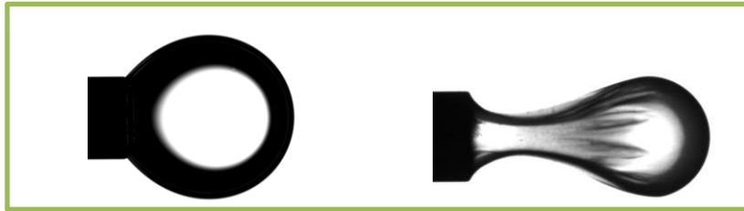
Abbildung 75: Aufnahmen eines hängenden Tropfens am Pendant-Drop -Tensiometer. Oberhalb der Schwellenkonzentration von OTS bildet sich eine Membran an der Wasser/ n -Dodecan-Grenzphase. Links) Vor der Volumenkontraktion. Rechts) Nach der Volumenkontraktion ist die Membranbildung (Falten) zu erkennen.
