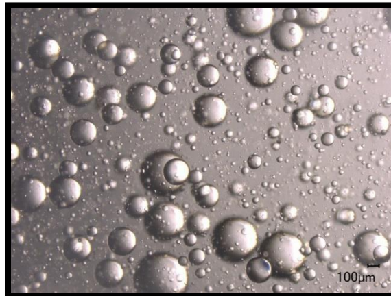
Abbildung 114: Lichtmikroskop-Bild einer am Ultra-Turrax hergestellten und mit OTS-Mikrogelen stabilisierten Emulsion mit \varphi_i = 10\% nach 60 Tagen. Äußere Phase: Glycerin/Wasser-Gemisch, Innere Phase: p -Xylol/TCB-Gemisch.
