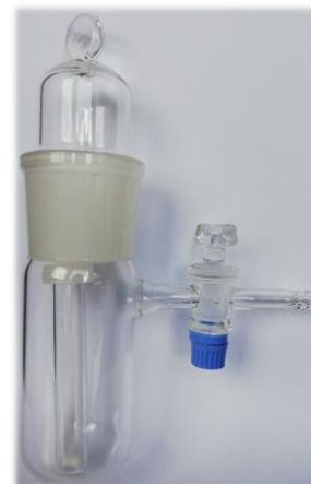
Abbildung 5.6: Im eigenen Arbeitskreis entwickelte Apparatur zur Vorbereitung von Proben für den Einsatz in einer Labormikrowelle.
