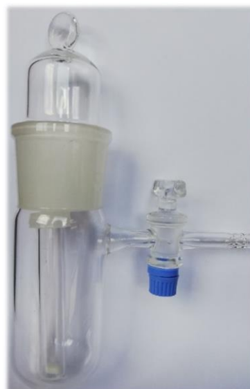
Abbildung 4.38: Apparatur erster Generation zur Vorbereitung empfindlicher Proben für den Einsatz in der Mikrowelle.
