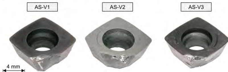
Abbildung 8.9: Schneidkantenbrüche der angepassten Schneidengestalten im Werkstoff 42CrMo4+QT
