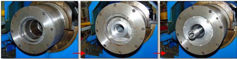
Abbildung 6.8: Montageabfolge am Bohrzuführapparat
