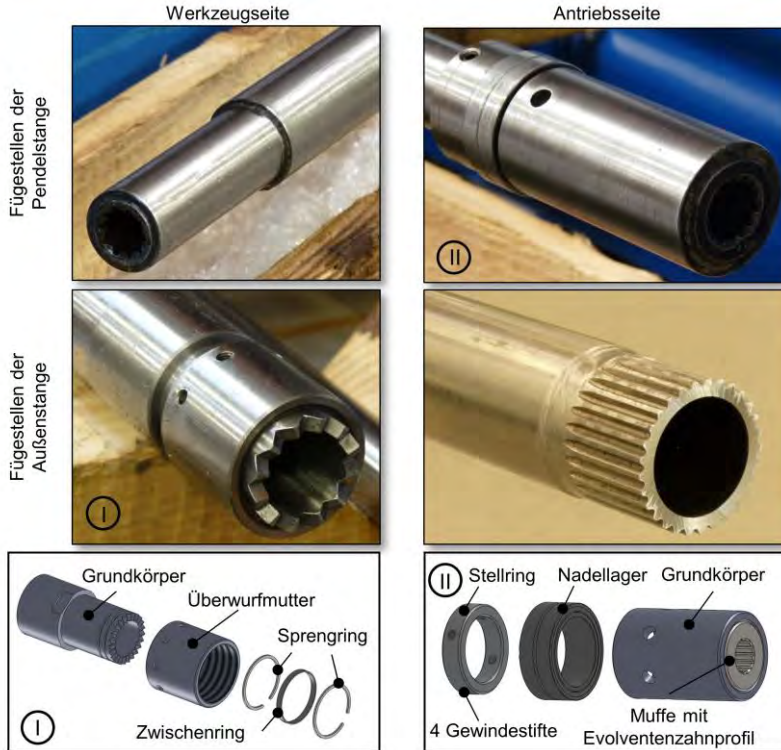
Abbildung 5.15: Bohrstangenenden zur Werkzeug- und Antriebsseite
