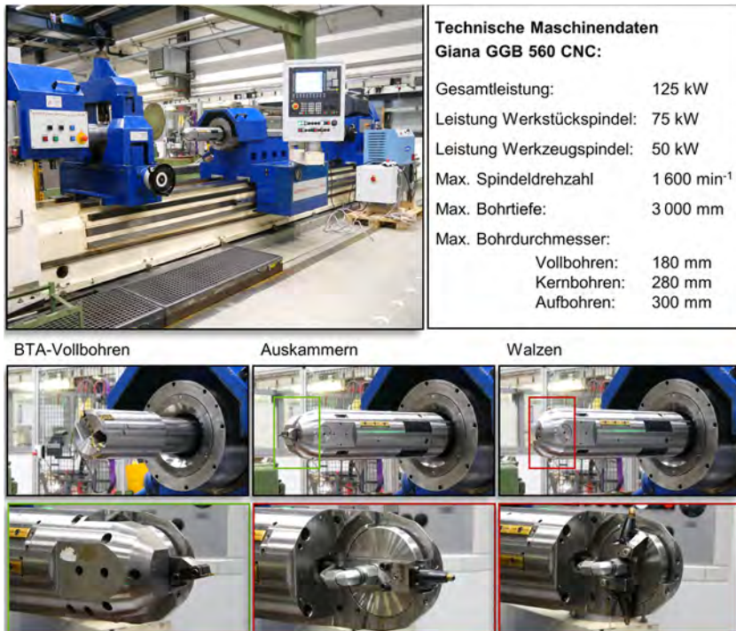
Abbildung 4.4: BTA-Tiefbohrmaschine Giana GGB 560 CNC
