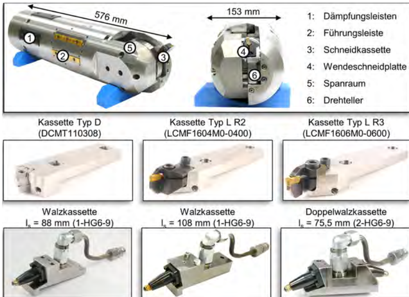
Abbildung 4.6: Auskammerwerkzeug und Darstellung unterschiedlicher Schneiden- und Walzkassetten
