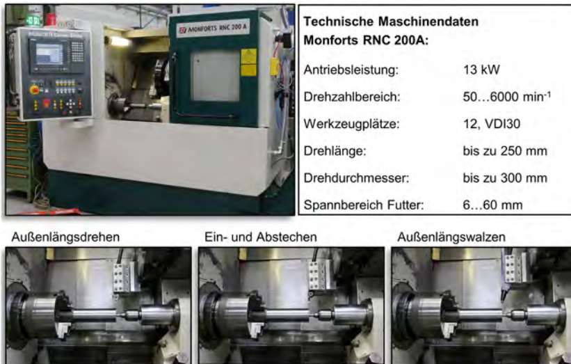
Abbildung 4.8: CNC-Drehmaschine Monforts RNC 200 A
