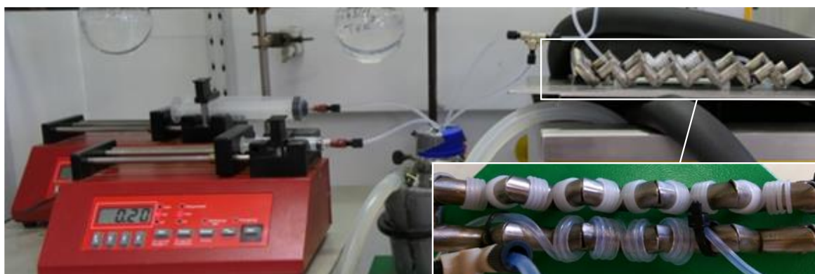
Abbildung 4.24: Foto vom Versuchsaufbau inklusive Nahaufnahme des gewickelten Mikroreaktorschlauchs.
