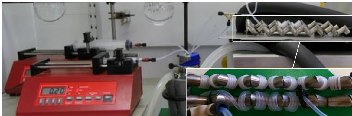
Abbildung 6.1: Skizze des Versuchsaufbaus (oben). Foto vom Versuchsaufbau (mitte), zu sehen sind die Spritzenpumpen, eine vorgeschaltete Kühlung und der Mikroreaktor. Nahaufnahme des gewickelten Mikroreaktorschlauchs (unten).
